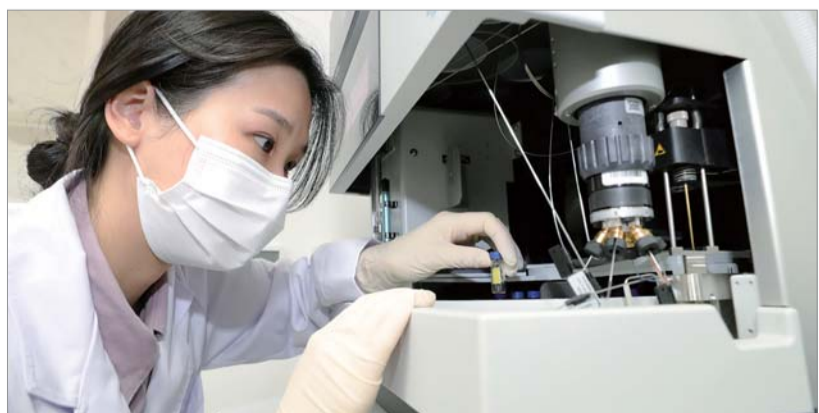
시험평가실 성능분석평가과 윤해근 군무주무관이 탄약 추진제 내 안정제 함량 분석을 위해 고성능액체크로마토그래피(HPLC) 기기에 샘플을 넣고 있다.
