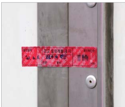
아스트라제네카 백신을 수송하는 차량에 부착된 ‘군 제작 특수봉인지’. 봉인지를 떼는 순간 색이 바뀐다.
