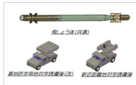
일본이 개발할 예정인 차량탑재형 지대공미사일 체계 구성도. 항공자위대가 사용할 미사일(왼쪽)은 4개의 발사대를, 육상자위대가 사용할 미사일(오른쪽)은 2개의 발사대를 갖추고 있다.
